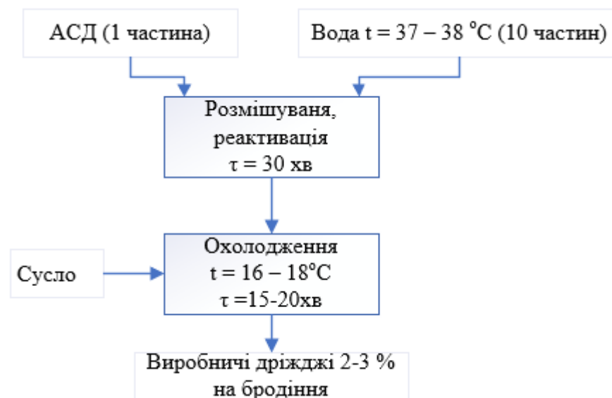
Рисунок 2.2 - Схема приготування виробничих дріжджів (АСД)
