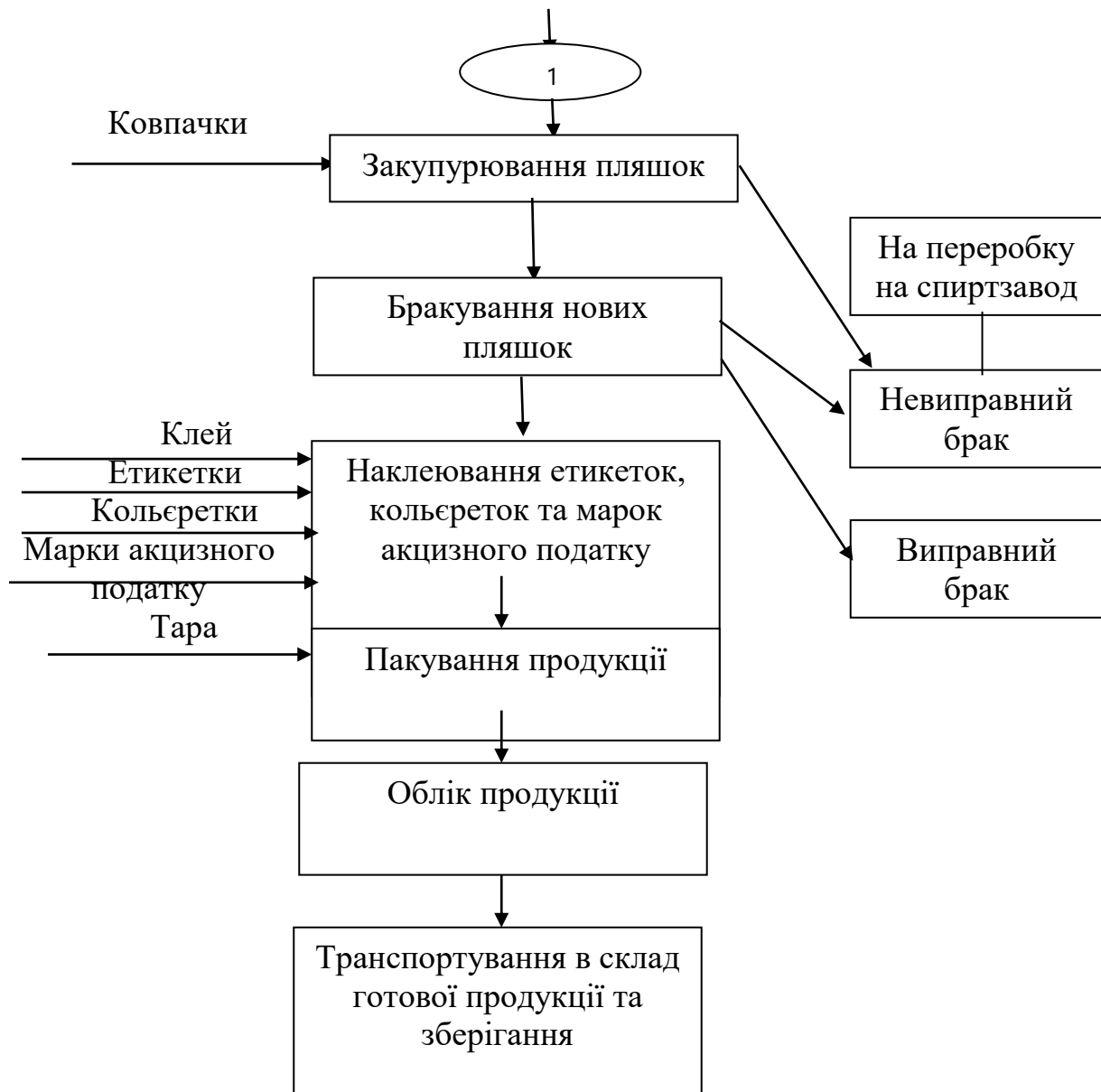
Рис.1 – Принципова технологічна схема виробництва горілок і горілок особливих
