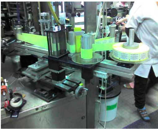
Рис.6 Пристрій розмотування та подачі плівкового матеріалу
