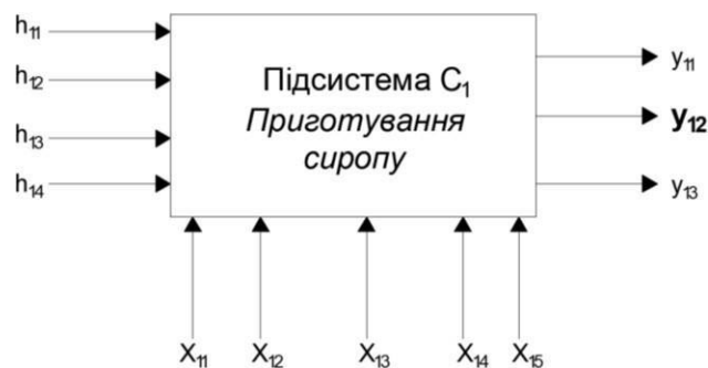
Рис. 3.7 – Параметрична схема приготування сиропу
