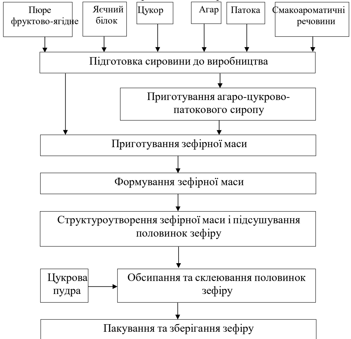
Рис. 3.1 – Технологічна схема виробництва зефіру на агарі
