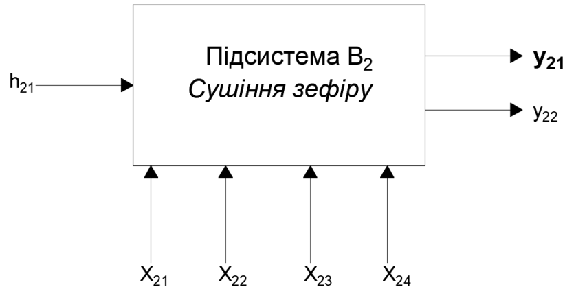
Рис. 3.10 – Параметрична схема сушіння зефіру
