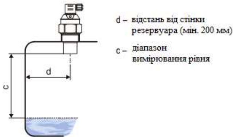
Рис. 4.4. Відстань між рівнеміром і стінкою резервуара
