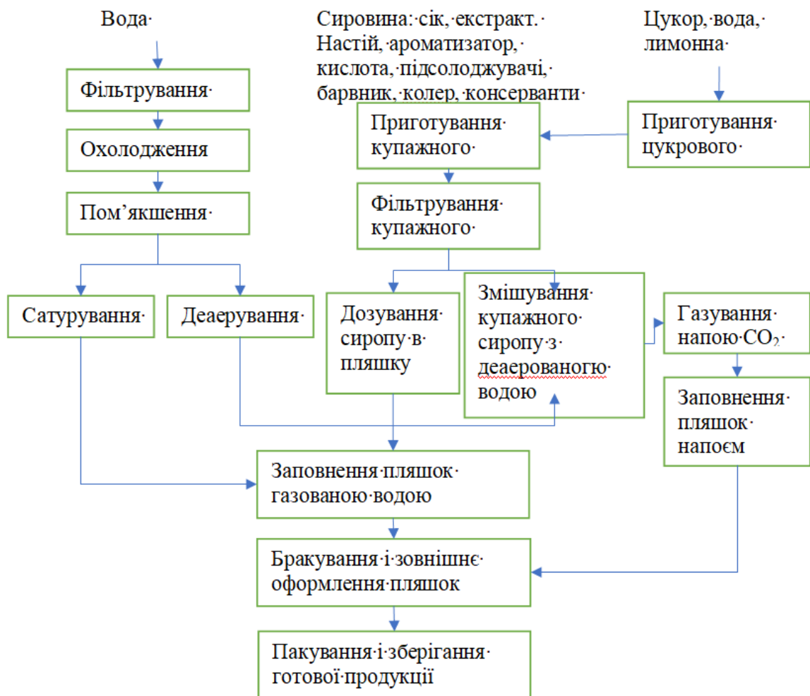
Рис. 1.1 - Принципово-технологічна схема виробництва безалкогольних напоїв
