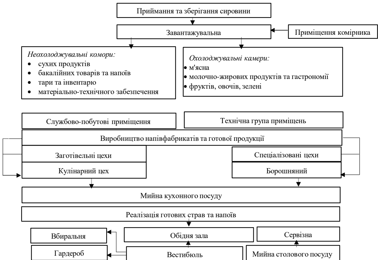
Рис.3.2 – Структурно – технологічна схема організації виробництва вареничної
