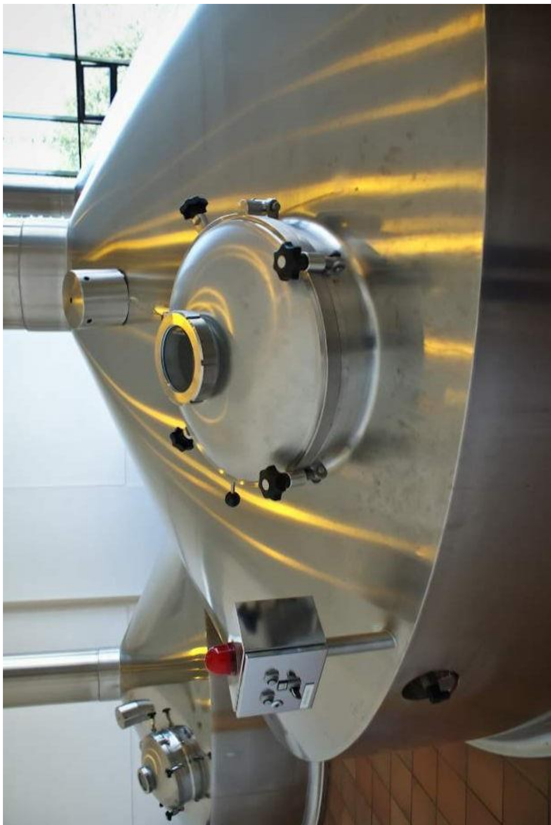
Рис. 1.2. Вид суслварочного котла.
