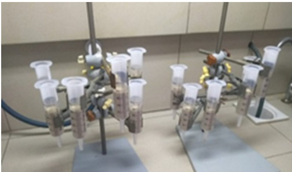
Рис. 2.6. Колонки з піском для проведення біоцементзації.
