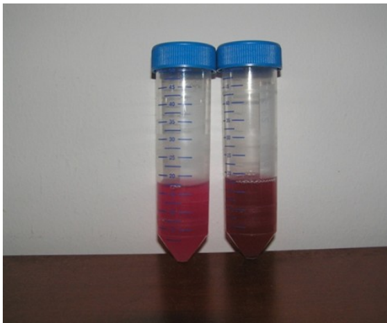
Рис. 2.1. Червоний колір показує підвищення рН до 8.2 середовища в якому відбувається ріст уреаз-продукуючих бактерій
