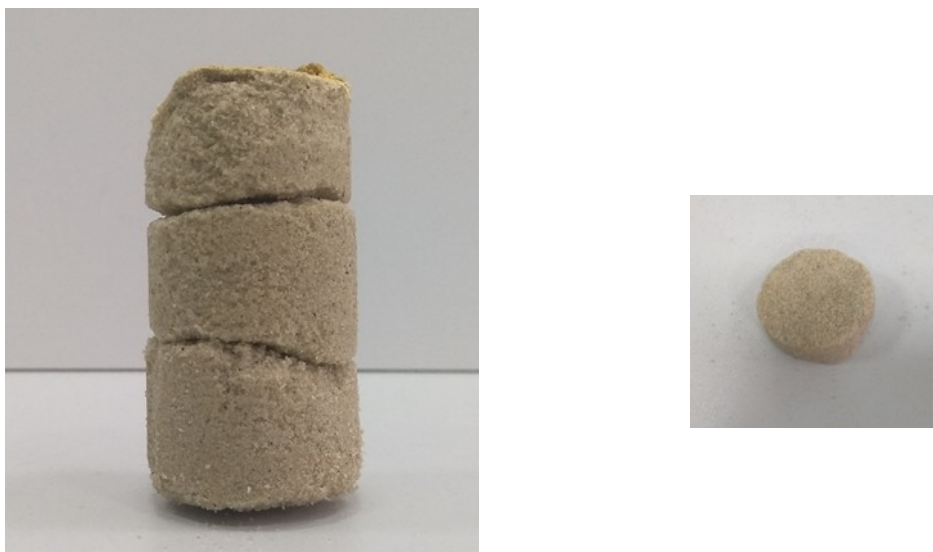
Рис. 3.11. Пісок, після біоцементациї зі застосуванням гідролізату кісткового борошна та зниженої кількості сечовини (0,25 М), гідроліз якої проходив під дією інактивованих клітин бактерій – продуцентів кислої уреаз.
