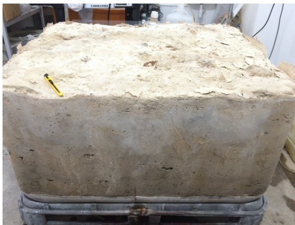
Рис. 1.4. Пісок, який було штучно перетворено на камінь біоцементуванням за допомогою штаму уреаза-продукуючих бактерій Bacillus sp. VS1 (із Ivanov та Stabnikov, 2017).
