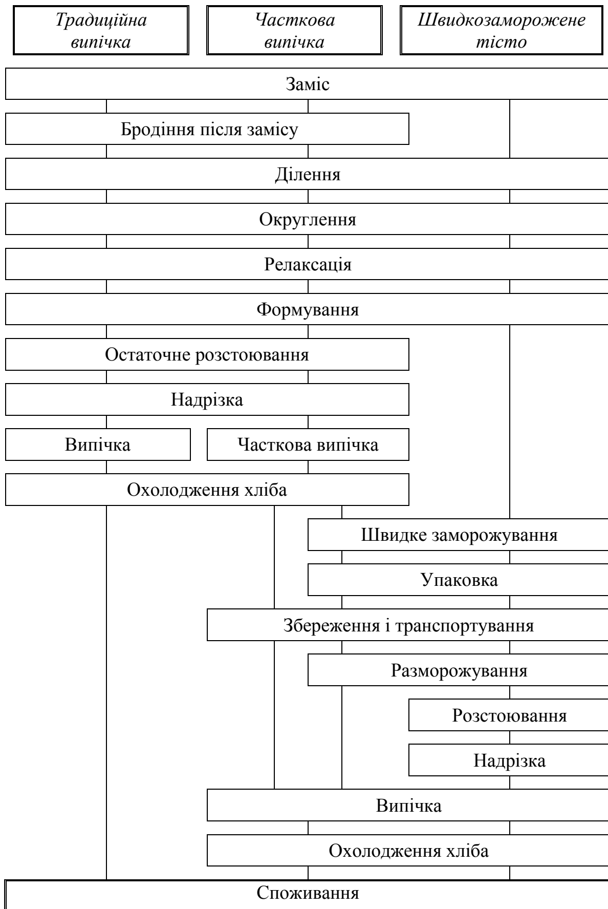
Рис. 3. Різноманітні технології виробництва хлібобулочних виробів із використанням технологій швидкого заморожування.
