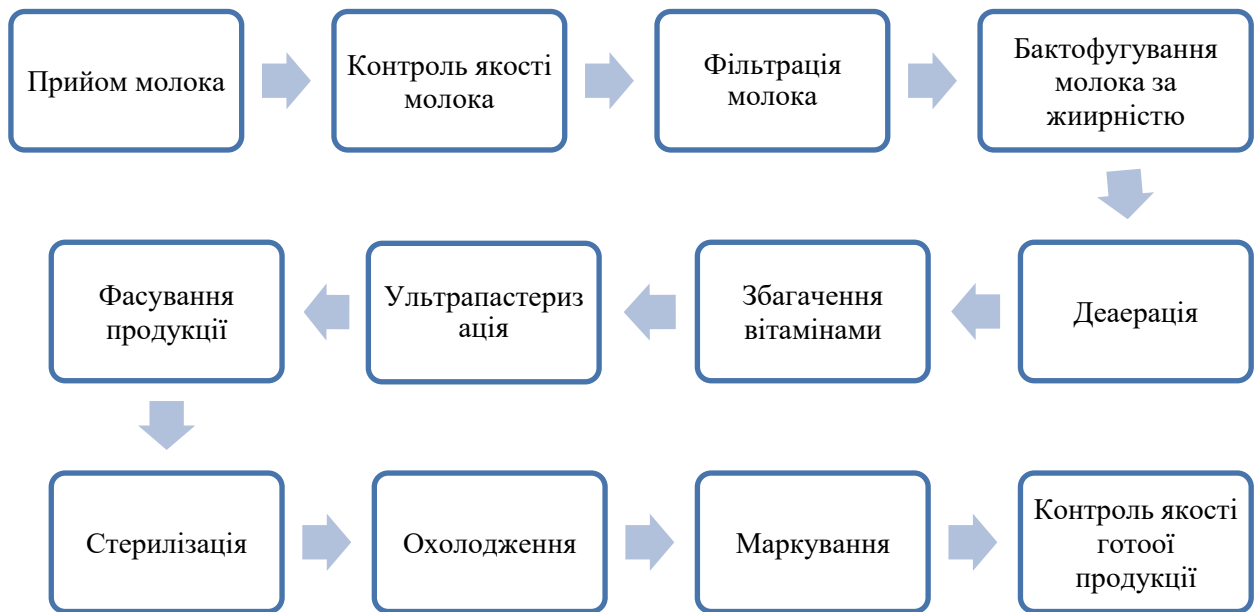
Рис. 2.3. Схема послідовності процесів виробництва продукції у ТДВ «Яготинський маслозавод»
