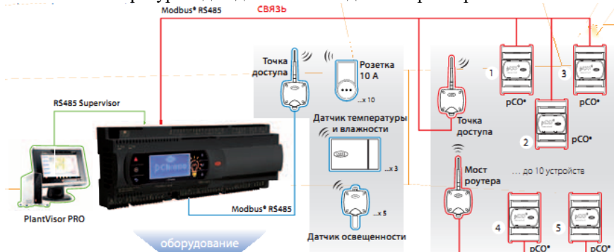
Рис.1. Приклад схеми підключення споживачів
