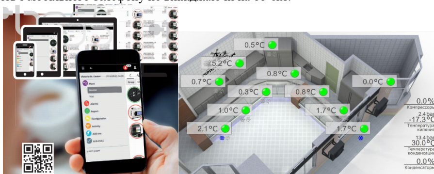
Рис.1. Приклад реалізації системи диспетчеризації, мнемосхема об'єкта
