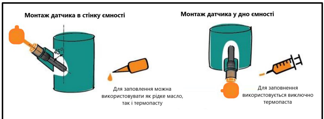
Рис. 4.4. – Монтаж датчика температури KOBOLD LTS-A у ємність
