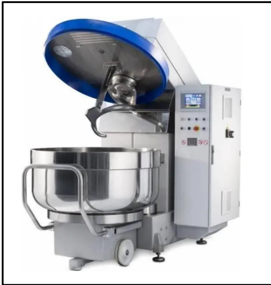
Рис. 2.1. – Зовнішній вигляд тістомісильної машини MIXER PRO E 300
