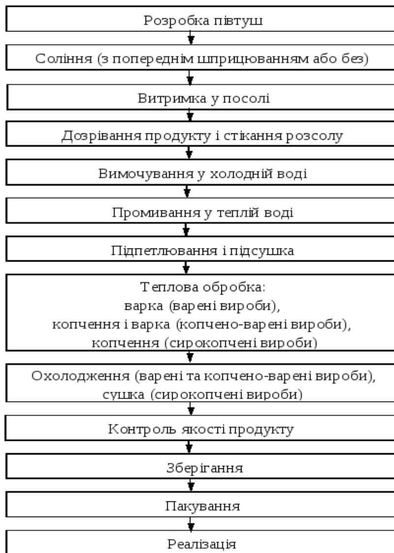
Рис. 2.2. Технологічна схема виробництва продуктів із свинини, яловичини, баранини
