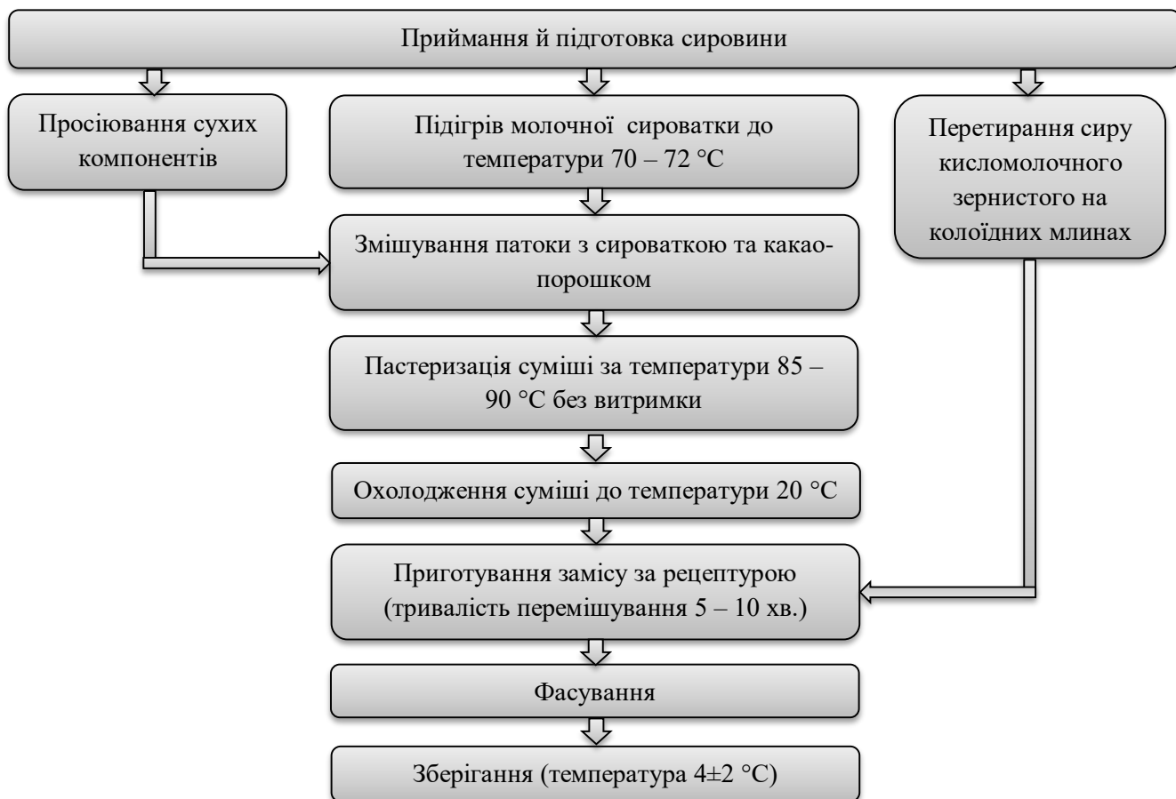
Рисунок 1.10 – Технологічна схема виробництва сиркового виробу з патокою
