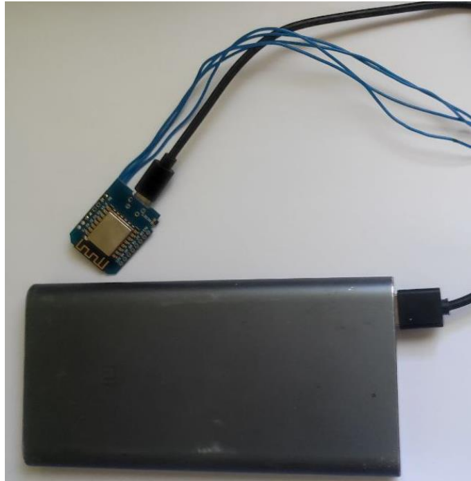
Рисунок 3.33 – Підключення мікроконтролера до елемента живлення за допомогою кабелю USB-A – microUSB
