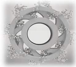
Рис. 6. Циркуляції бісеру в млині з турбінним робочим органом [7]
