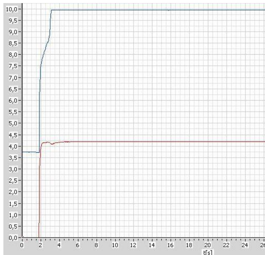
Рис.3.3.2 Зусилля різання горловини ПЕТ-пляшки
