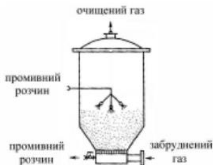
Рис.6. Іонообмінний апарат з псевдозрідженим шаром іоніту[47]
