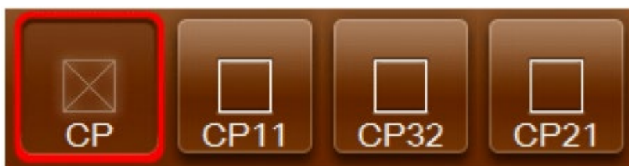
Рис. 9.2.5. Екранні кнопки вибору програмних кроків: CP – Змішуюча установка, CP11 – Деаерація; CP32 – Буферний танк; CP21 – Дозування сиропу.
