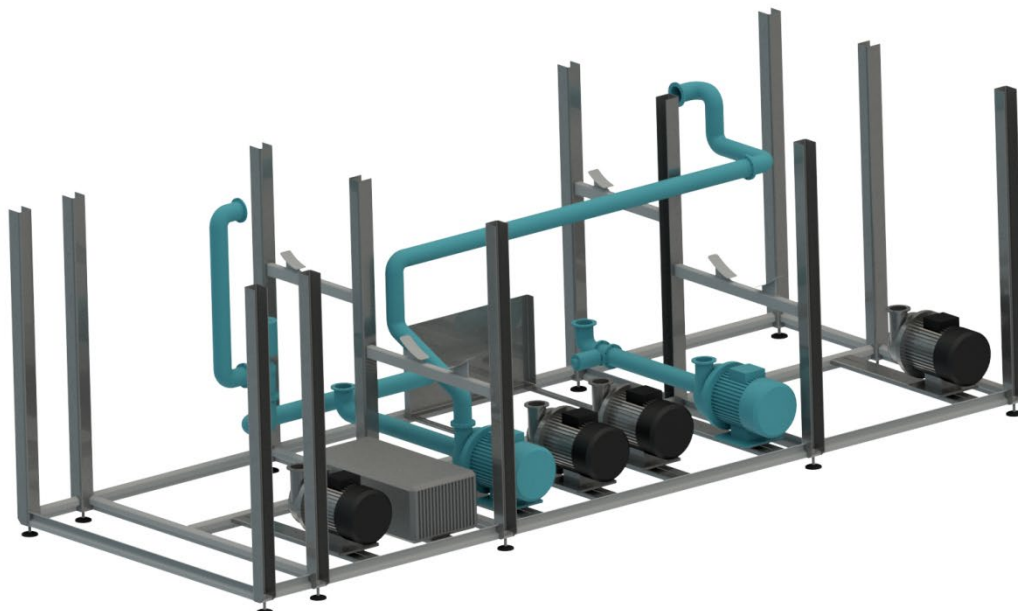
Рис. 9.1.3. Монтаж труб та запірної арматури продуктової води
