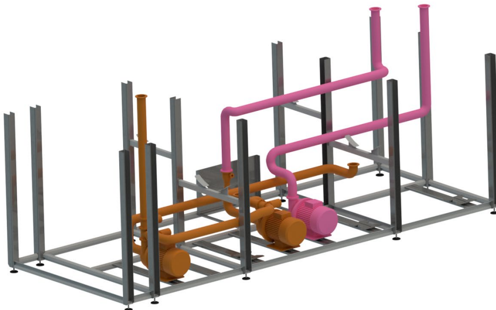
Рис. 9.1.5. Монтаж труб та запірної арматури готового та напівготового напоїв
