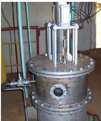
Рис.1. Реализация мехатронной подсистемы управления циклами ректификации
