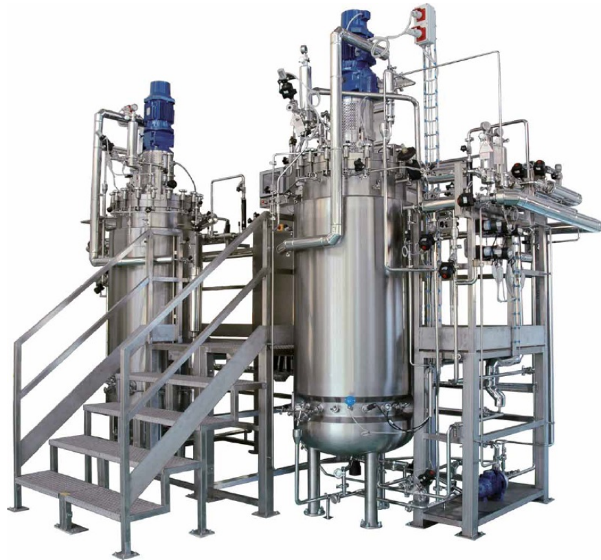
Рис 5.1. Промисловий ферментер фірми «Solaris» [35].
