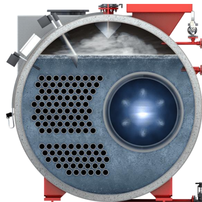
Рис.1.11. Поперечний переріз котла UL-S
