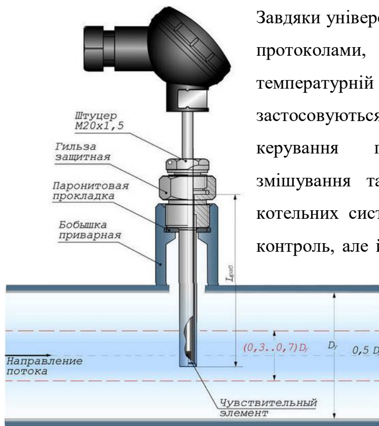
Схема монтажу датчика температуры
