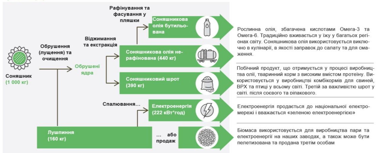
Рис. 2.2 Процес переробки насіння соняшника (Джерело: розроблено автором на основі даних підприємства ).
