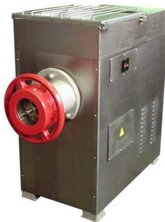
Рис. 4.2. – Зовнішній вигляд вовчка марки МП-160
