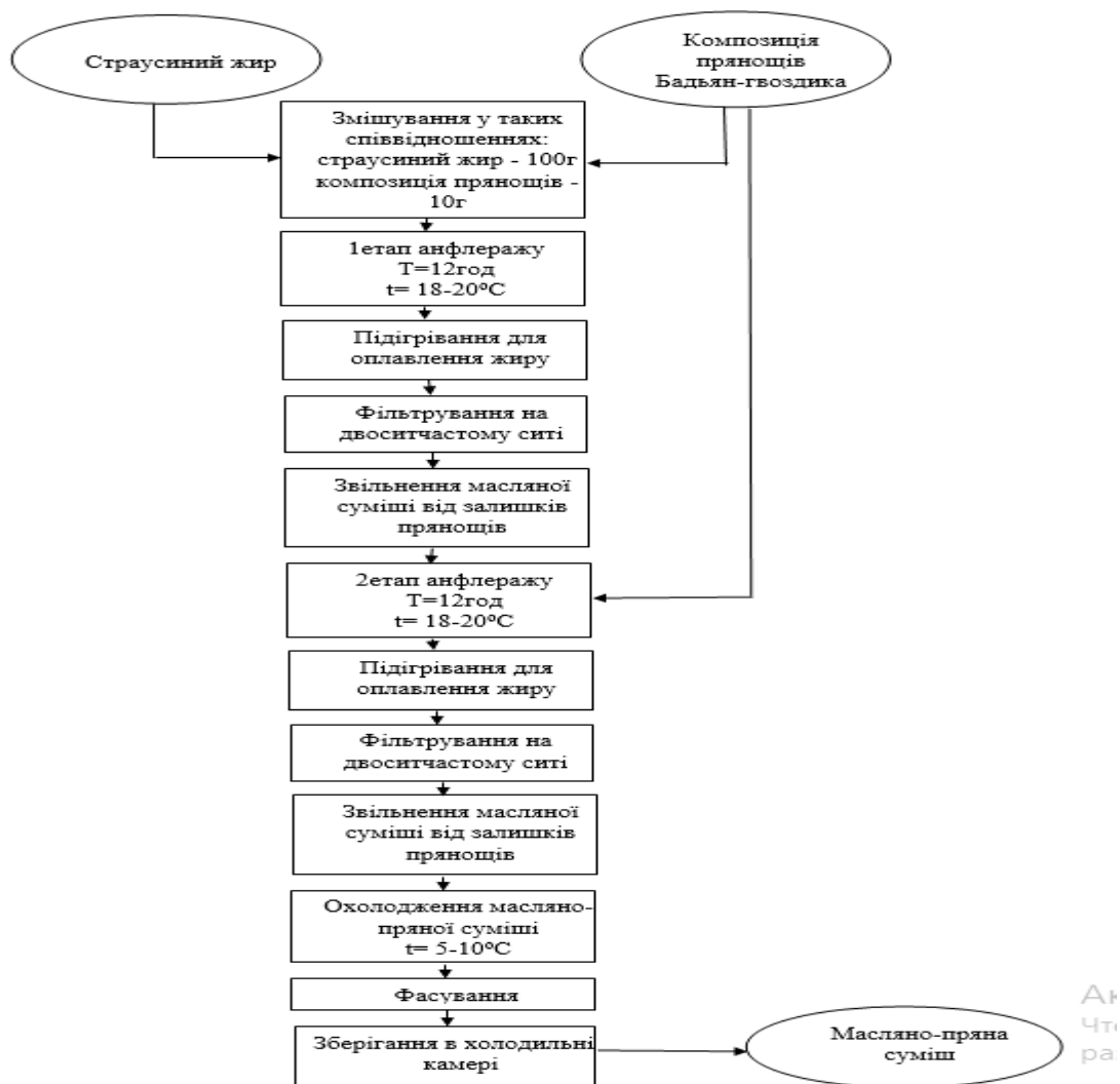
Рисунок 4.8 Технологічна схема отримання пряно-жирової помади
