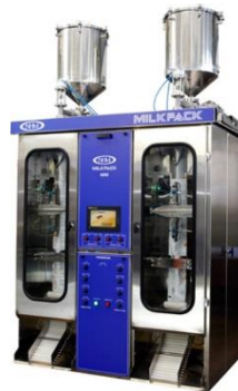
Рис. 4.4.1 – Фасувальний автомат Мілкпак
