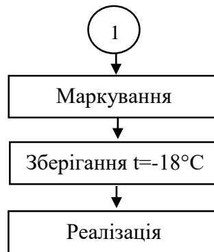
Рисунок 3.1. Діаграма послідовності технологічних етапів виробництва нагетсів
