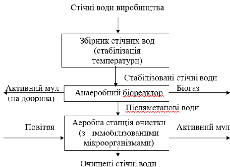
Рис.12.1 – Принципова технологічна схема двостадійної очистки стічних вод
