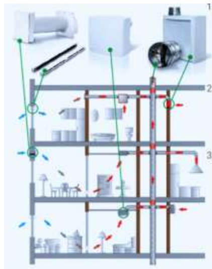
Рис.4.1- Система вентиляції в SPA-готелі
