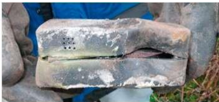
Рис.21. Пошкоджений датчик CO. [18]
