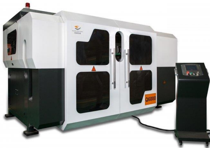
Рис.3.7. Обладнання видування ПЕТ-тари (ЕСО-формат з переробленого пластику) Автоматична видувна машина(Сервопривід Q 4000)
