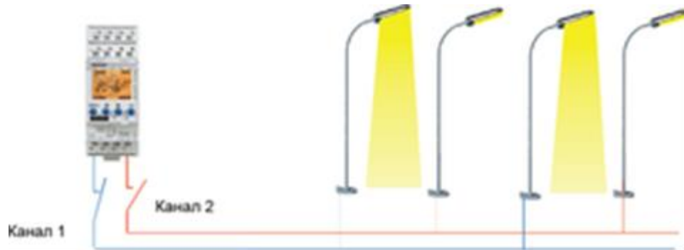
Рис.31 - Варіанти керування нічним освітленням у залежності від вибору реле.
