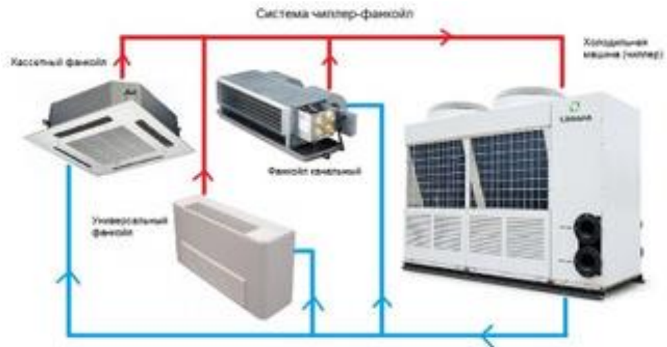
Рис.22 - Система кондиціонування повітря з чилер-фанкойлами
