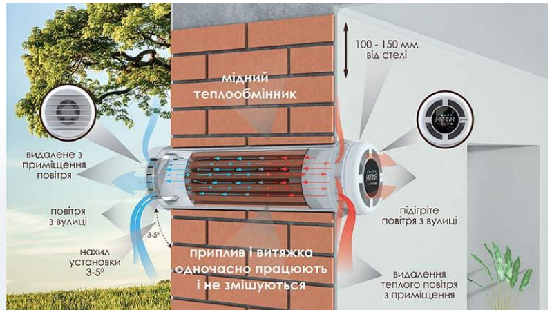
Рис.19 - Місцева припливно-витяжна установка з рекуперацією тепла
