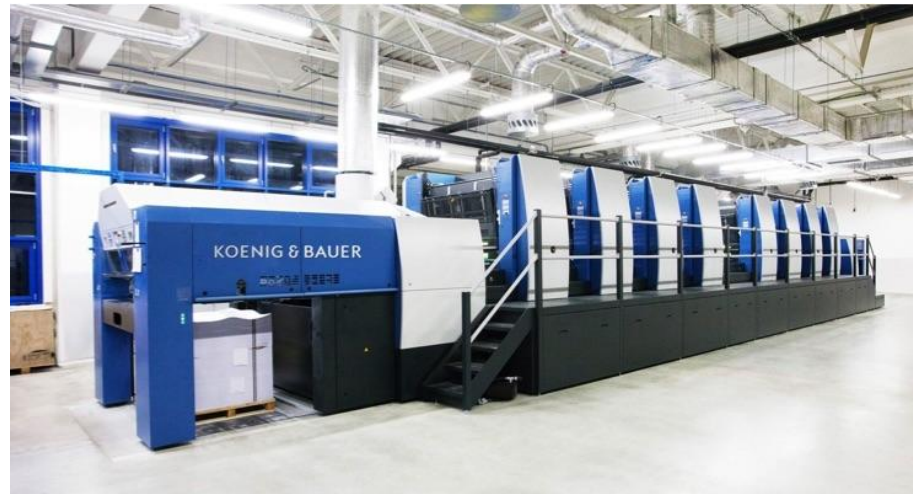
Рис. 4.3.2. Друкарська машина КВА Rapida 145-4+L+L
