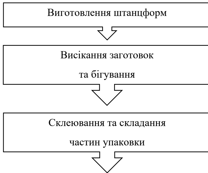
Рис. 4.1. Технологічна схема виготовлення упаковки
