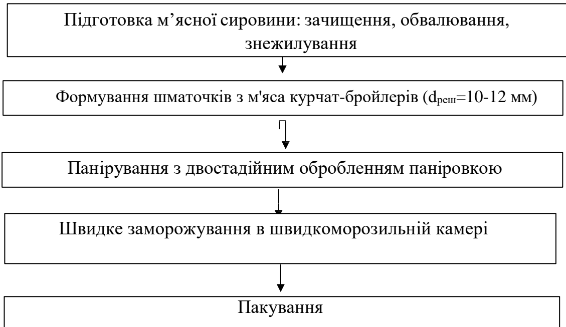
Рисунок. 3.2 - Технологічна схема виготовлення стріпсів з м'яса курчат-бройлерів в паніровці
