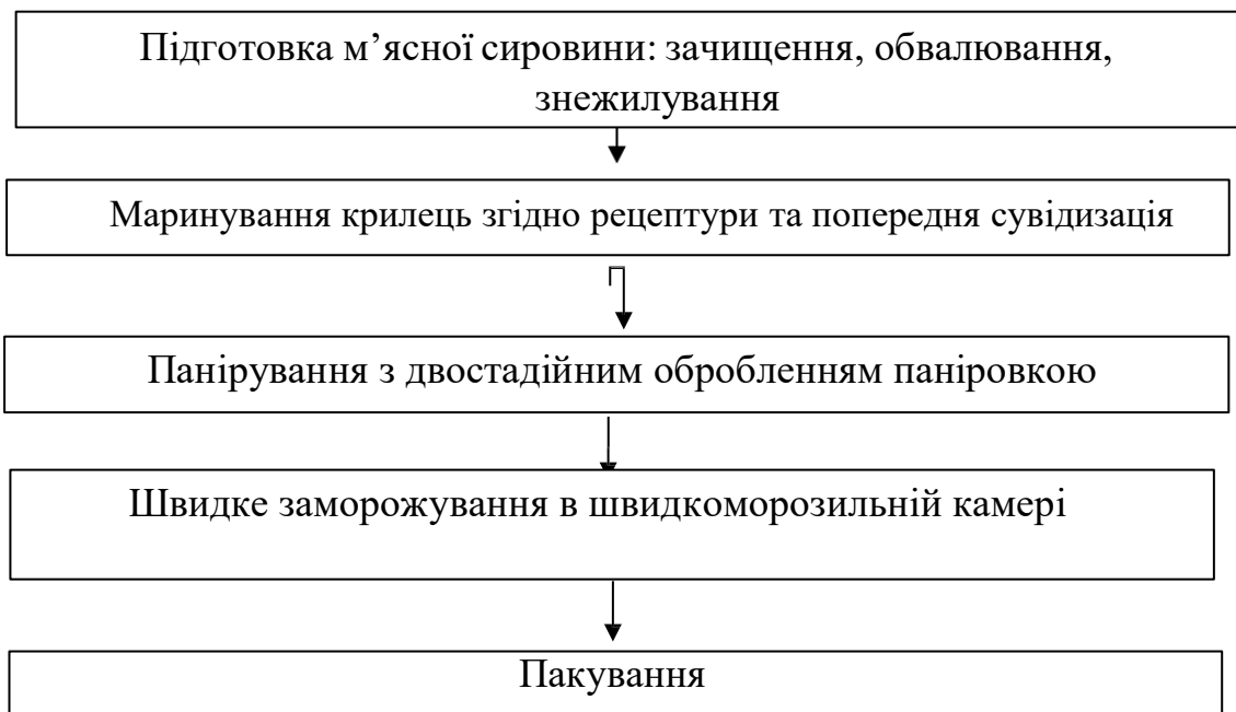
Рисунок. 3.3 - Технологічна схема виготовлення крилець з м'яса курчат-бройлерів в паніровці
