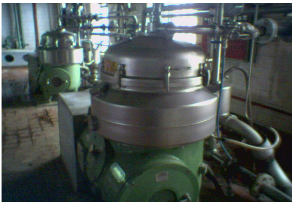
Рис. 7 Сепаратори типу HDA 75 06016, потужність двигуна – 45 кВт (АТЗТ "Одеський дріжджовий завод")
