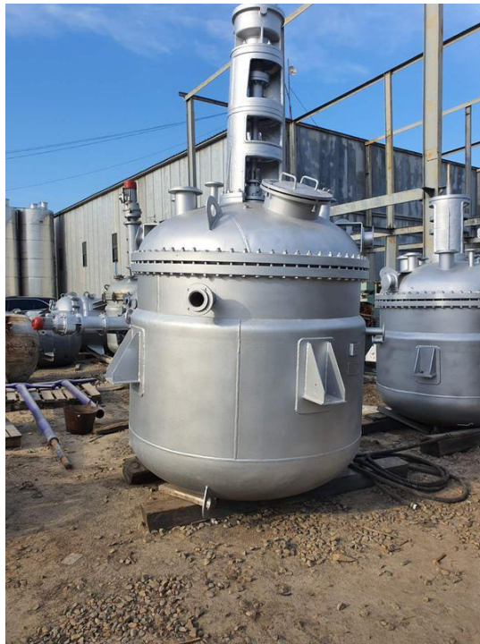
Рисунок 2.6 Реактора з якірною мішалкою
