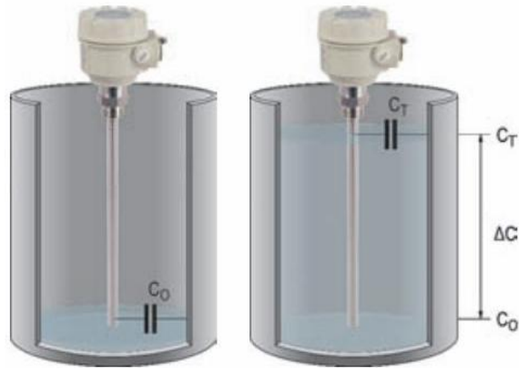
Рис.2.3. Принцип роботи рівнеміра
