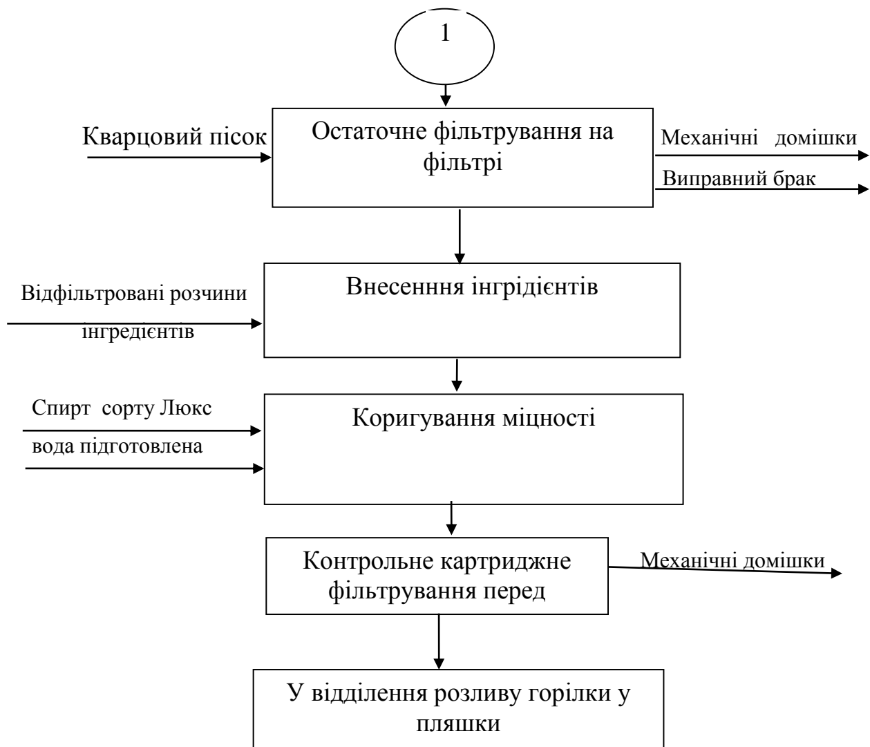
Рис. 2.1 – Принципова технологічна схема горілчаного виробництва періодичним способом
