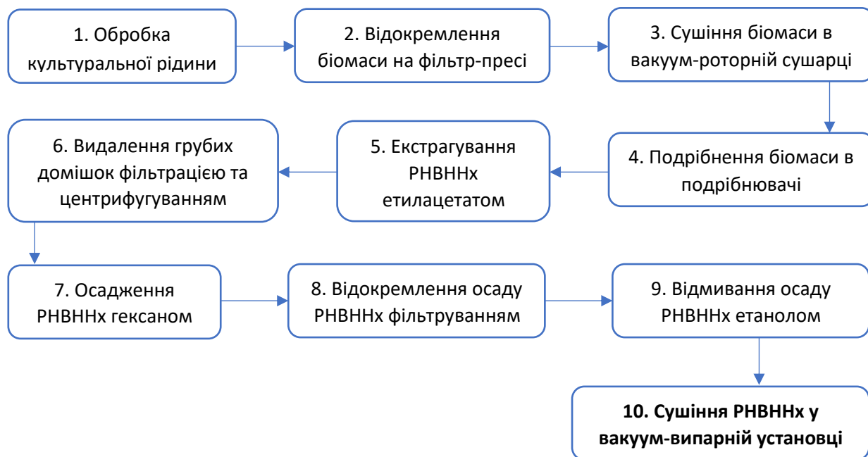
Рис.5.1. Схема виділення та очищення РНВННх
