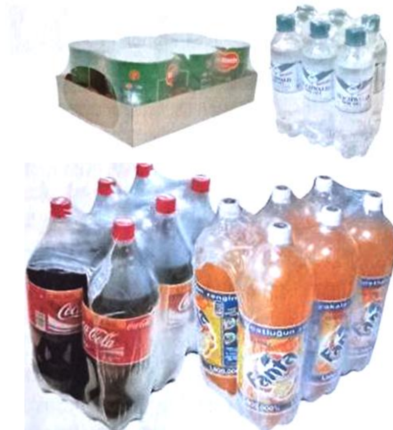
Рис. 3.2. Транспортна упаковка в термозбіжну плівку методом обгортання для жорсткої споживчої упаковки круглого перерізу
