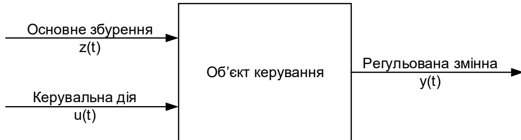
Рис. 7.2. Параметрична схема по каналу регулювання температури охолодження молока в резервуарі.
