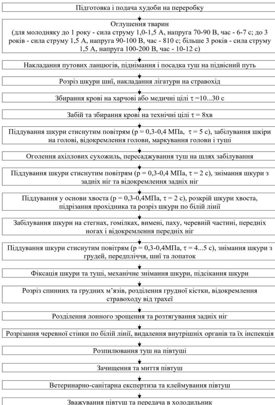
Рис 2.1. Технологічна схема переробки великої рогатої худоби.
