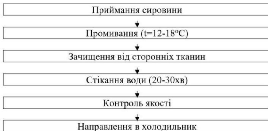
Рис.2.7. Технологічна схема оброблення м'ясо-кісткових хвостів
