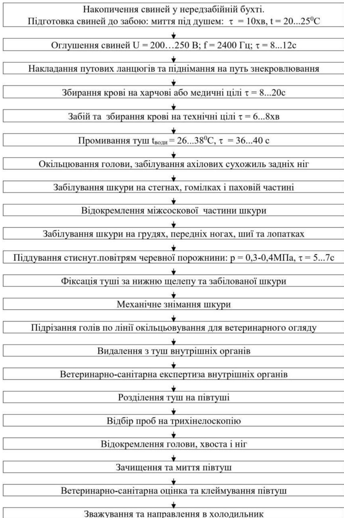
Рис.2.3. Технологічна схема переробки свиней зі зняттям шкіри.
