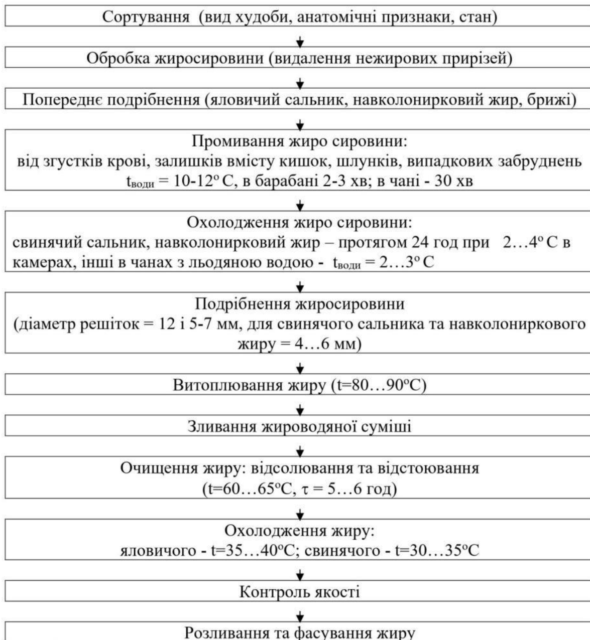
Рис. 2.14. Технологічна схема витоплювання жиру в автоклаві.
