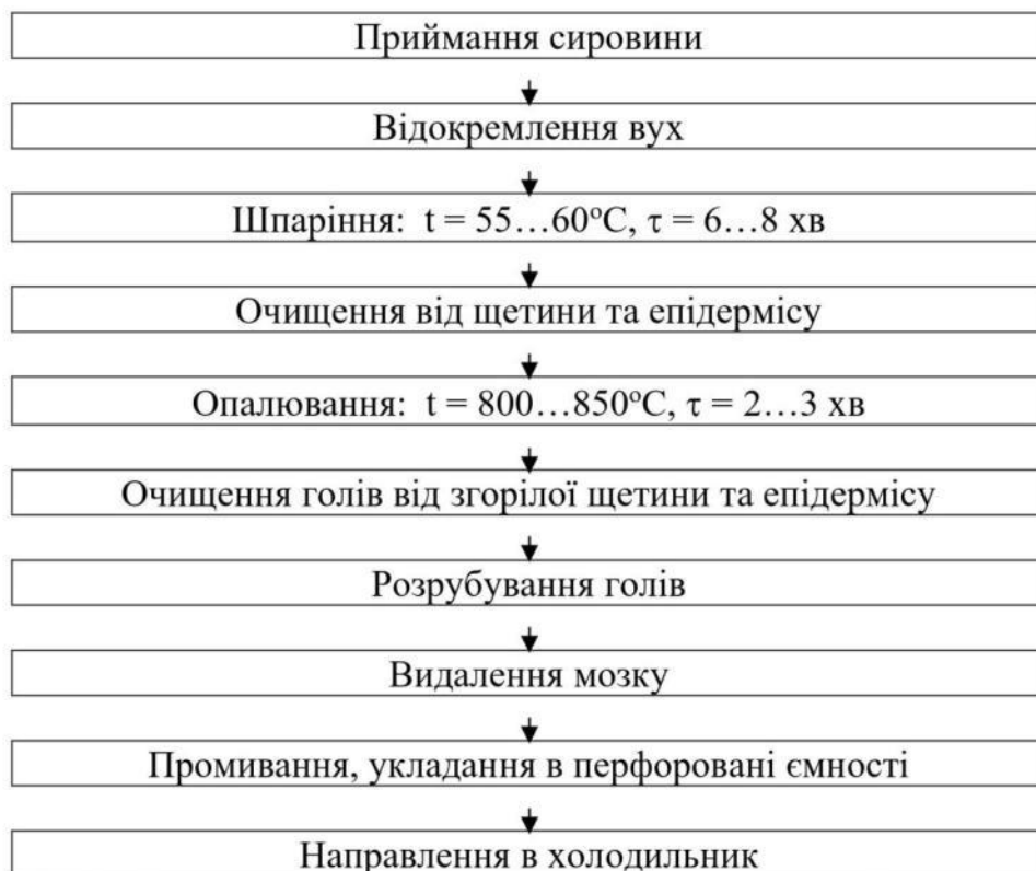
Рис.2.8. Технологічна схема обробки свинячих голів
