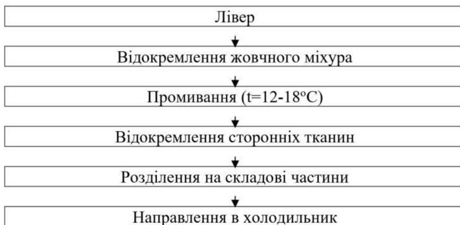
Рис. 2.5. Технологічна схема обробки м'якушевих субпродуктів
