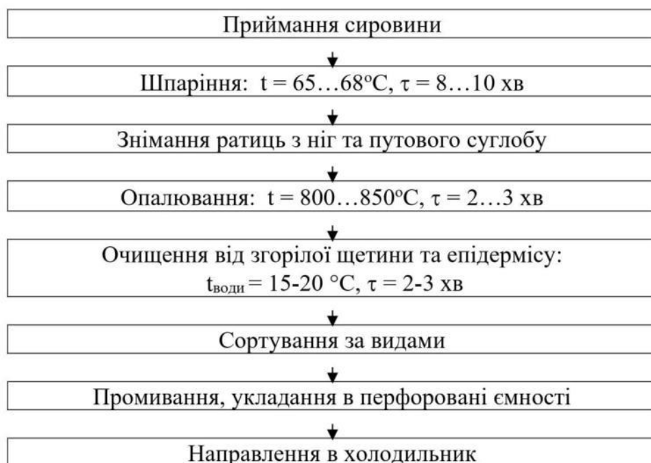
Рис. 2.9. Технологічна схема обробки шерстних субпродуктів Обробка слизових субпродуктів
