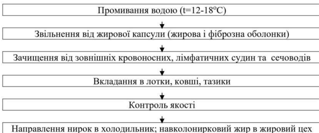
Рис 2.6. Технологічна схема обробки нирок
