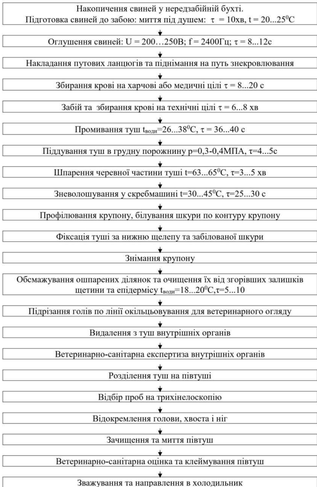
Рис.2.4. Технологічна схема переробки свиней зі зняттям крупонів.
