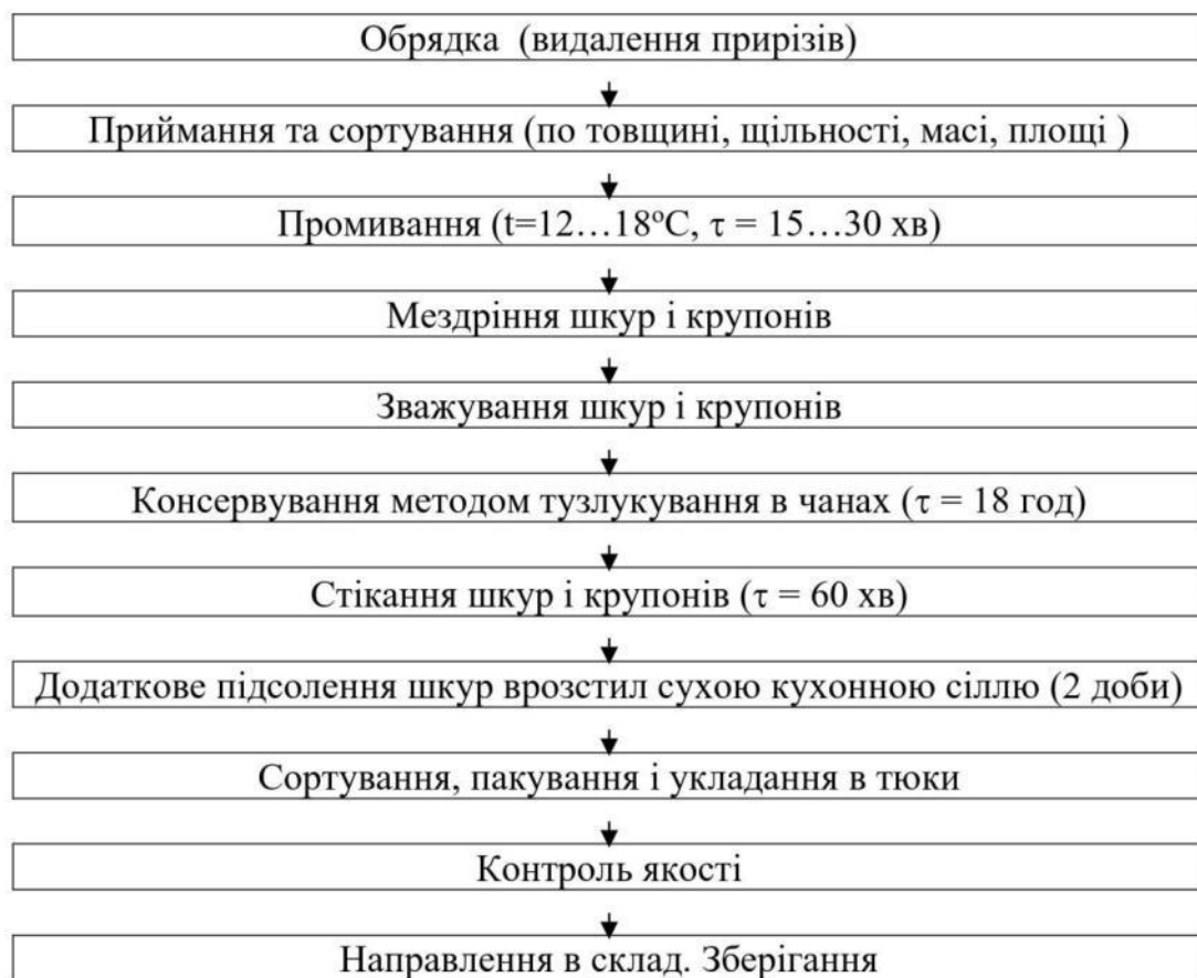
Рис. 2.13. Технологічна схема обробки шкур свиней та крупонів Жировий цех
