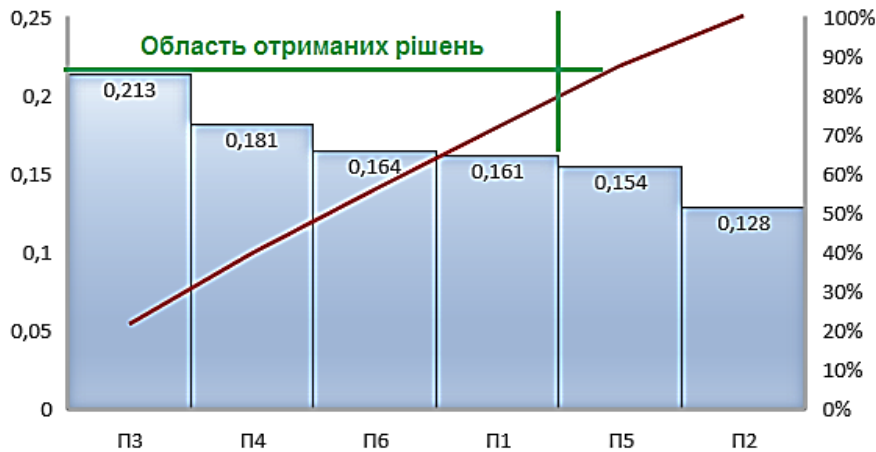
Рис.2. Діаграма Парето вибору оптимального варіанту мехатронного модуля для технологічної операції піднімання.
