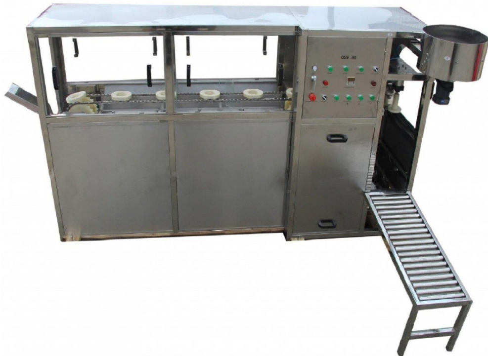
Рис. 3.2. Лінія розливу іонізованої води у пляшки по 19л FGQ 120
