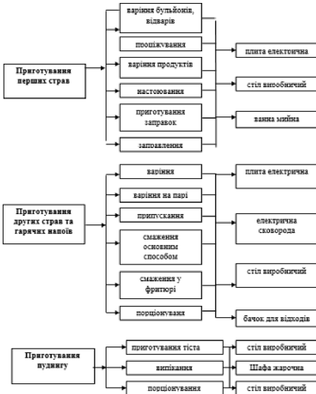
Рис. 3.5. - Технологічний процес у доготівельному цеху
