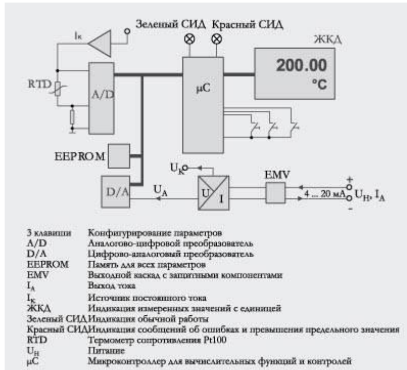
Рис. 4.2 - Принцип дії вимірювального перетворювача температури SITRANS TF2
