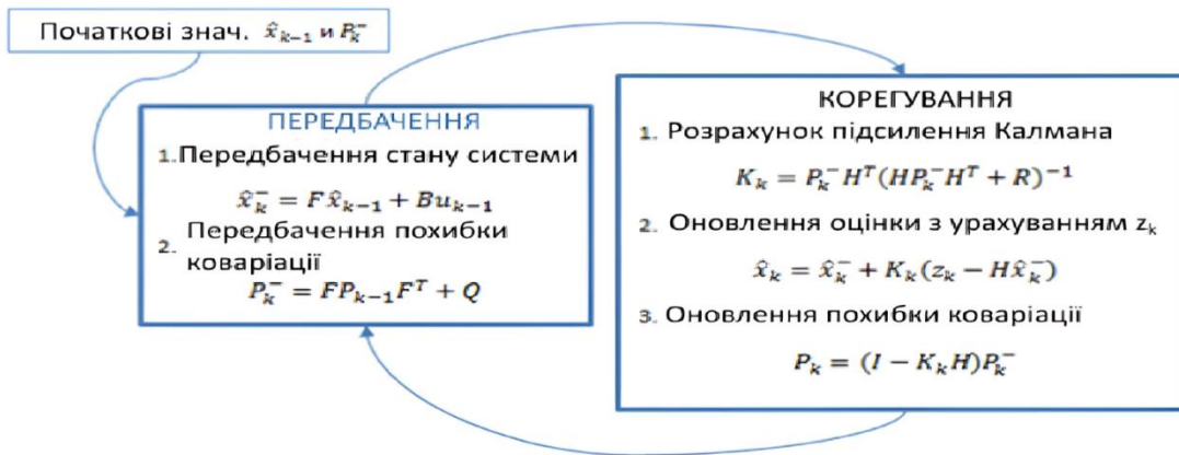
Рисунок 1.9. Алгоритм роботи першої та другої фази фільтра Калмана Рівняння на рис. 1 подано в матричній формі. Їх подано в матричній формі при вимірюванні двох змінних
