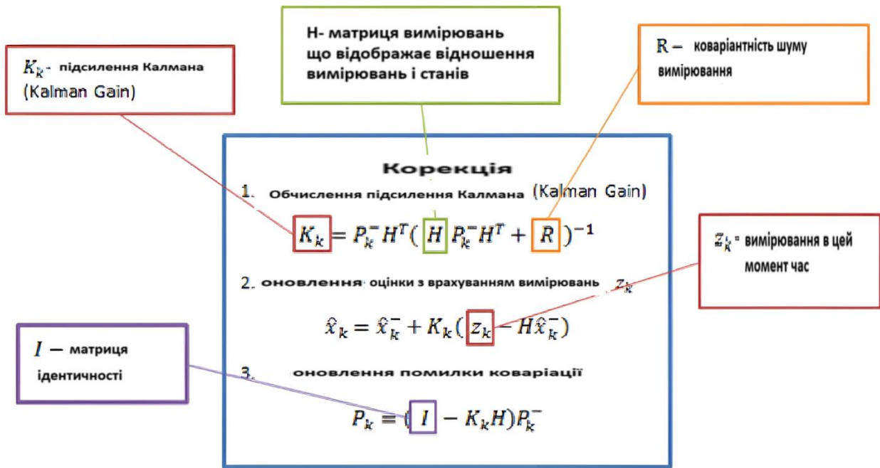
Рисунок 1.11. принцип роботи фільтра, частина друга.
