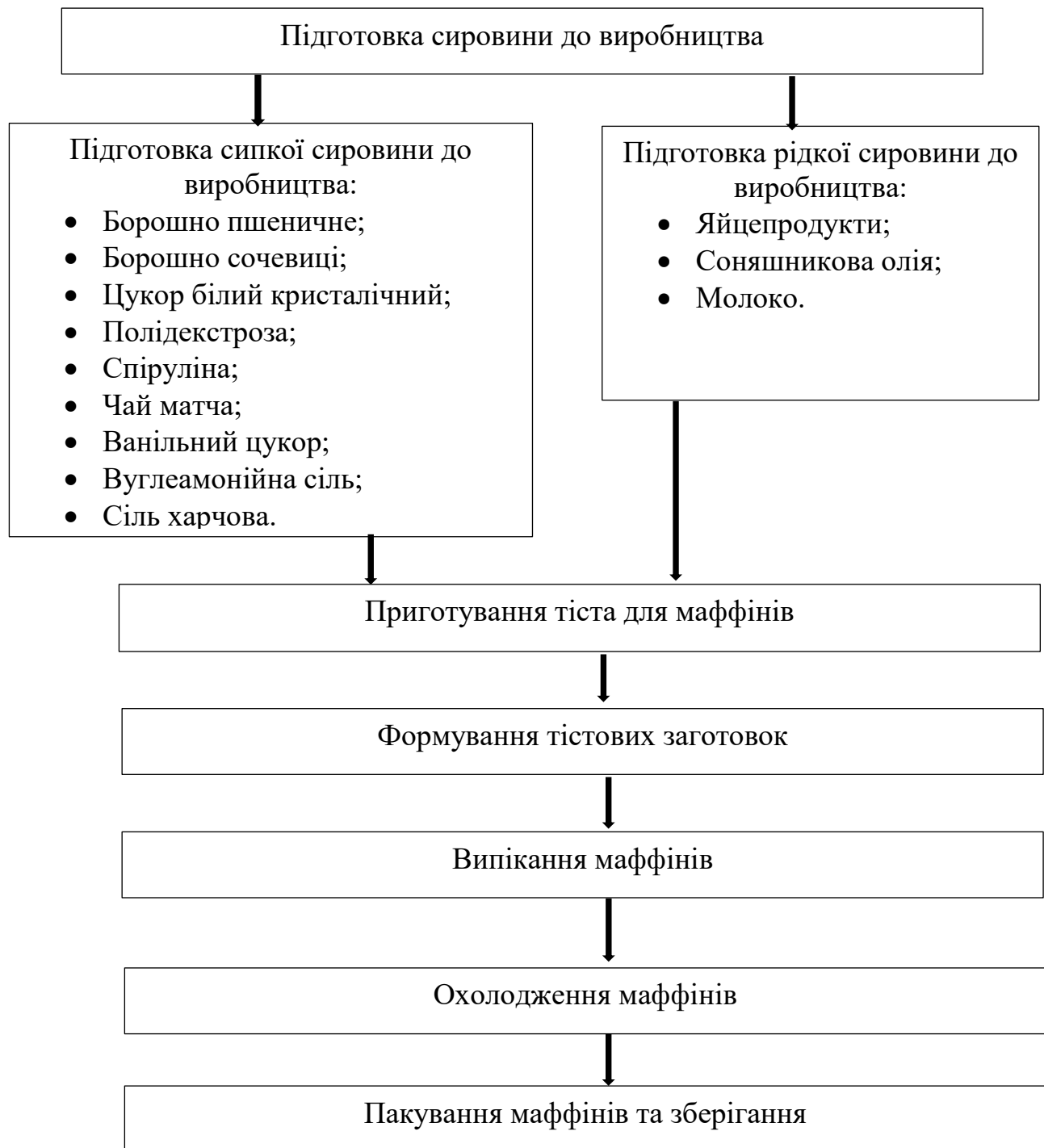
Рис. 1.3.6. Принципова схема виробництва маффінів «Смарагдовий»
