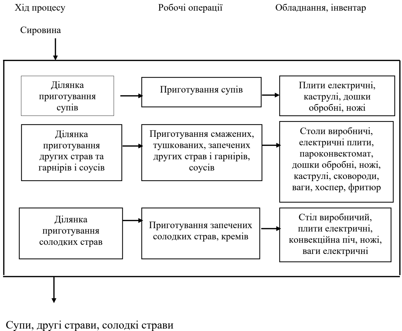
Рис.3.5. - Структурно-технологічна схема організації роботи в гарячому цеху ресторану «BEER SET».
